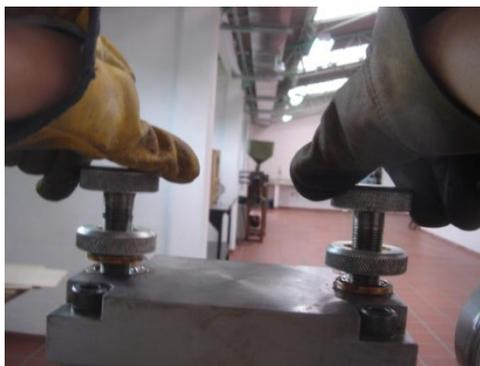
**Figura 15.** Ajuste de rodillos de laminación, utilizando los tornillos.
