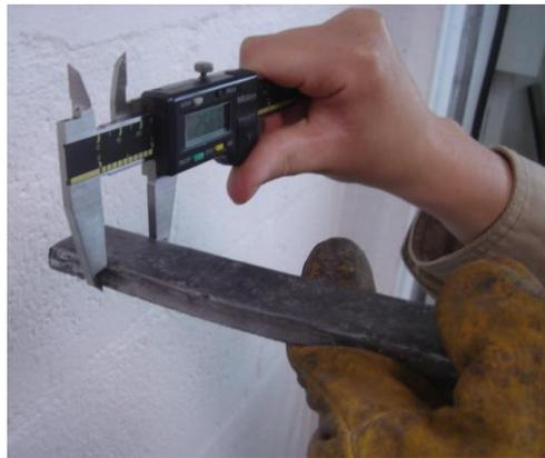
**Figura 14.** Medición del ancho de una lámina de estaño
