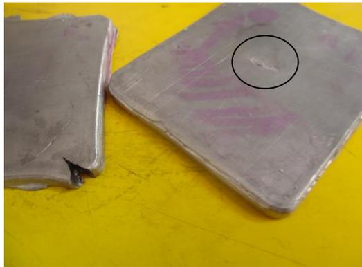
**Figura 3.** Láminas con presencia de grietas.
