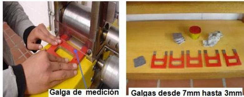
**Figura 11.** Galgas de medición
