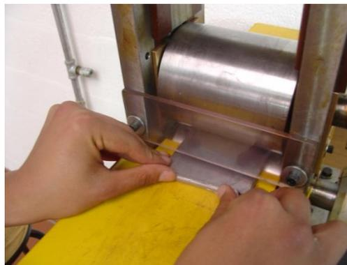
**Figura 2.** Laminado en frío de una lámina de estaño
